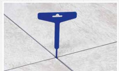
Dopo la posa delle lastre è possibile utilizzare la **ErgoSpeed** chiave di regolazione per il riallineamento (con fuga da 4 mm)
