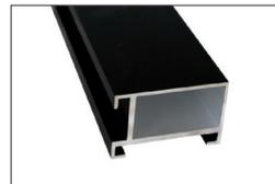
Altezza della struttura 40 mm per il fissaggio invisibile di tavole di legno oppure di WPC o per l'incollaggio di rivestimenti in HPL e ceramica, gres porcellanato, piastrelle e molto altro ancora. Campata 95 cm.
